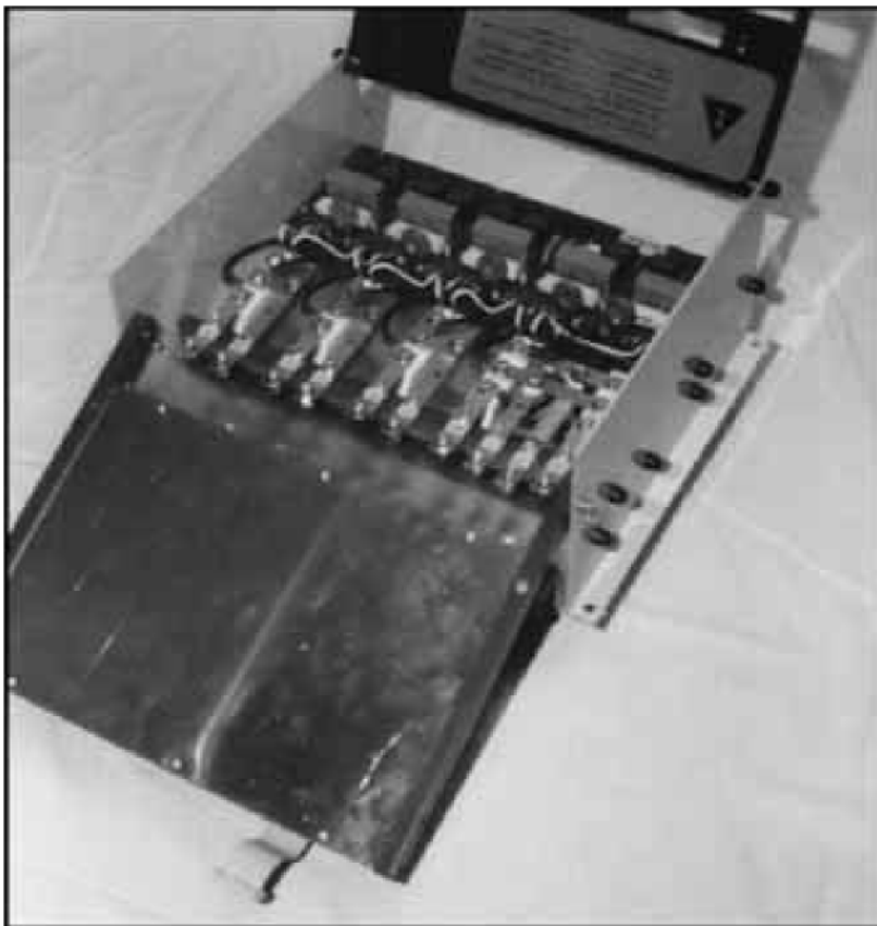
Bild 3.7 Hochklappen der Frontplatte, Herunterklappen der Leiterkarte (rückseitiges Alu-Abschirmblech sichtbar, am unteren Bildrand die abgezogene Flachsteckverbindung zum Anschluss des Leistungsteils
